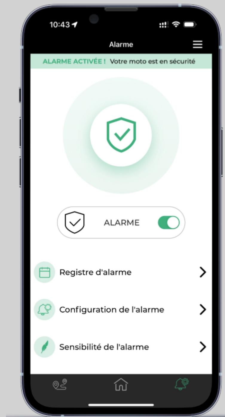
KOMOBI propose deux types d'alarmes. L'alarme de mouvement détecte tout mouvement que la moto subit et déclenche immédiatement l'alarme. L'alarme de zone crée un périmètre virtuel autour de la moto ; si elle sort de ce périmètre, l'alarme se déclenche. Cela permet d'éviter de recevoir de fausses alarmes.
