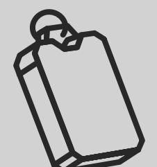
Le porte-clés sert à vous identifier en tant que propriétaire de votre moto, évitant ainsi les déclenchements accidentels d'alarmes. Il est complètement étanche et a une autonomie d'environ 3 mois, rechargeable facilement via un câble magnétique inclus dans l'emballage
